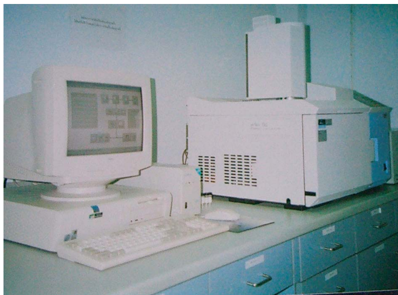
ภาพประกอบ 18 การวิเคราะห์ด้วยเครื่อง GC/FPD เพื่อวิเคราะห์หาสารกำจัดศัตรูพืช ก ลู่ ม อ อ ร ัก า โ น ฟ อ ส เ ฟ ต
