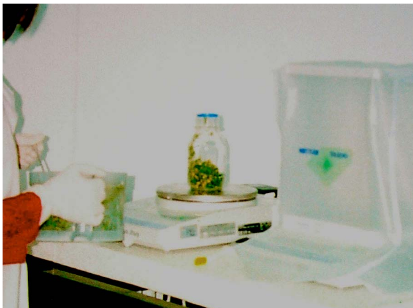
ภาพประกอบ 11 การชั่งตัวอย่างพริกปริมาณ 50 กรัม ใส่ขวดชั่งตัวอย่าง
