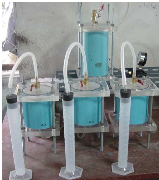
ภาพประกอบที่ 2-6 แสดงชุดการทดลอง Column Leaching Test
