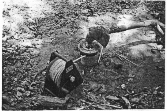
รูปที่ 2-1 เครื่องวัดระดับน้ำ Maßbandlänge Meter รุ่น Kabellichtlot Type010 (ซ้าย) และวิธีการตรวจวัดระดับน้ำ (ขวา)
