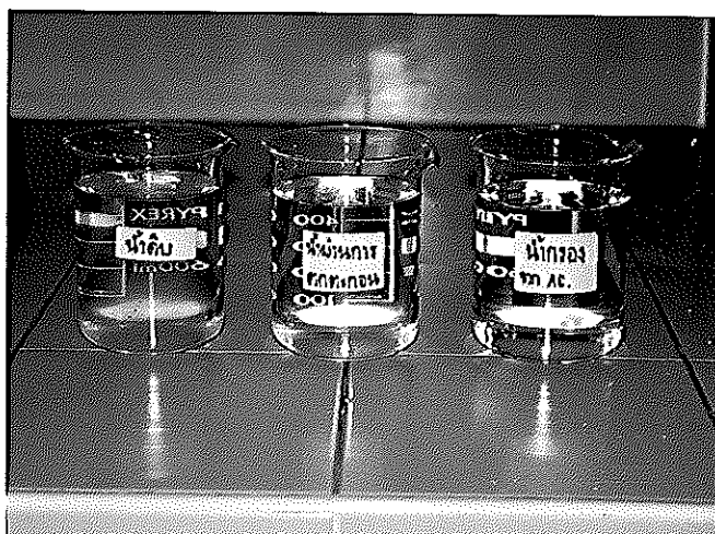
ภาพประกอบ 36 แสดงลักษณะสีของน้ำดิบก่อน และ หลังผ่านการกรอง ด้วยถ่านกัมมันต์
