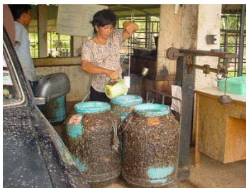
ภาพประกอบที่ 4-3 พนักงานทำการตักน้ำยางจากแต่ละถังมาผสมกันก่อนนำไปหา %DRC
