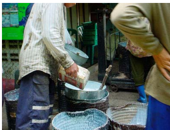
ภาพประกอบที่ 4-3 พนักงานทำการตักน้ำยางจากแต่ละถังมาผสมกันก่อนนำไปหา %DRC
