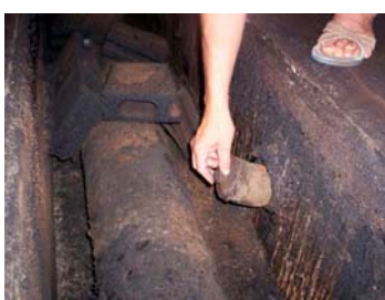
ภาพประกอบที่ 4-25 การหาวัสดุมาปิดท่อให้ความร้อนของเตารุ่นปี 2538
