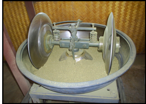
ภาพภาคผนวกที่ 2 แสดงเครื่องบดหยาบแบบใช้รางบด
