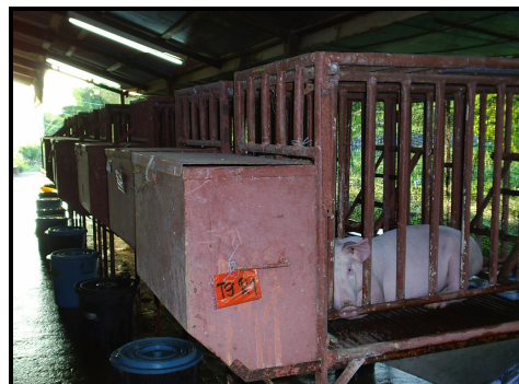
ภาพภาคผนวกที่ 10 แสดงลักษณะกรงศึกษาการ ย่อยได้ของสุกร (metabolism cage)
