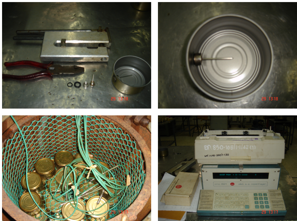
ภาพประกอบภาคผนวกที่ 1 อุปกรณ์ที่ใช้ในการศึกษาการส่งผ่านความร้อน ของเมล็ดมะม่วงหิมพานต์บรรจุกระป๋อง
