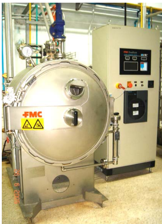
ภาพที่ 2-1 เครื่องฆ่าเชื้อแบบ steam water spray automated batch Steam water spray automated batch retort
