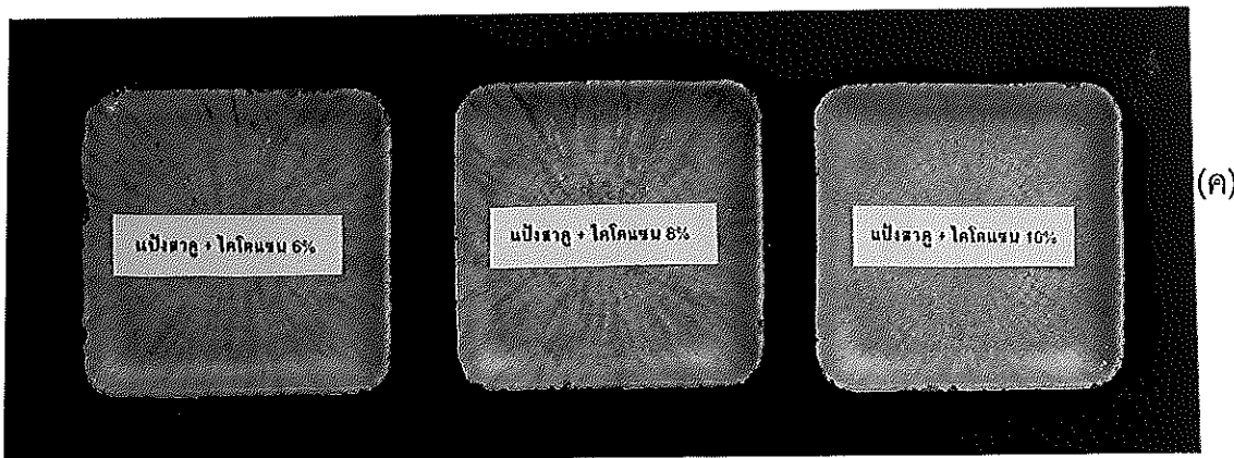
ภาพที่ 22 ถาดจากแป้งสาธสูตรพื้นฐานที่มีส่วนผสมของเปลือกกุ้ง (ก) ไคติน (ข) และ ไคโตแซน (ค)
