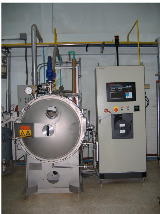
**ภาพที่ 10 เครื่องฆ่าเชื้อแบบ steam water spray automated batch**
