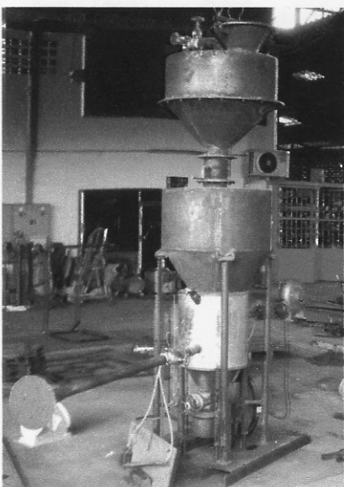
รูปที่ 5.3 เตาผลิตก๊าซแบบไหลลงที่ใช้ทดสอบ
