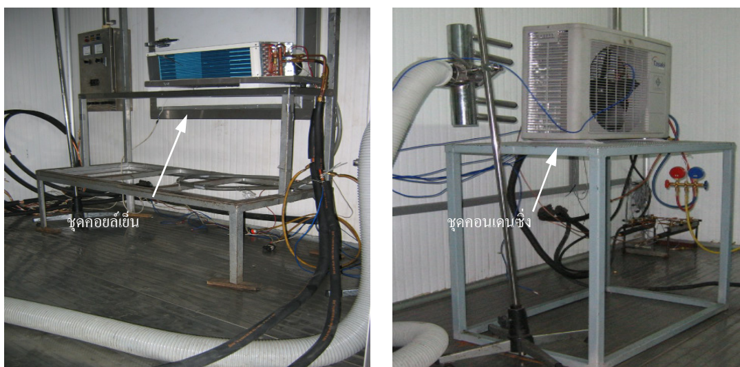
รูปที่ 3.11 การติดตั้งชุดคอยล์เย็น(รูปซ้าย) และการติดตั้งชุดคอนเดนซิ่ง(รูปขวา)
