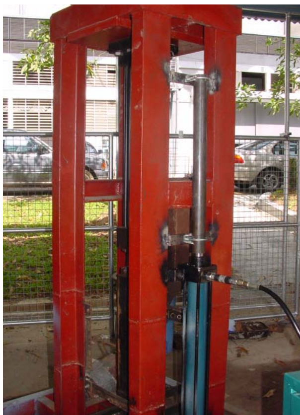
รูปที่ 3.12 แสดงชุดทดลองการดูฝุ่นด้วยกระบอกไฮดรอลิก
