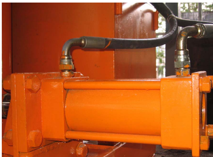
รูปที่ 4.9 กระบอกไฮดรอลิกกระบอกที่สาม
