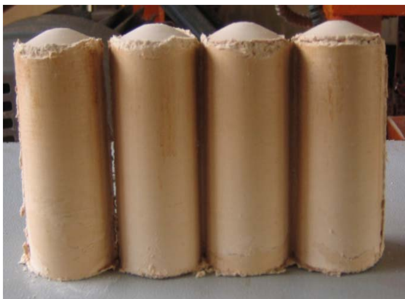
รูปที่ 4.20 แท่งฟุ้งไม้ที่อัดได้จากเครื่องอัดหลังจากทำการแก้ไข
