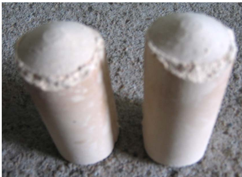
รูปที่ 4.17 แท่งฟืนไม้ที่อัดด้วยแบบอัดเทฟลอน
