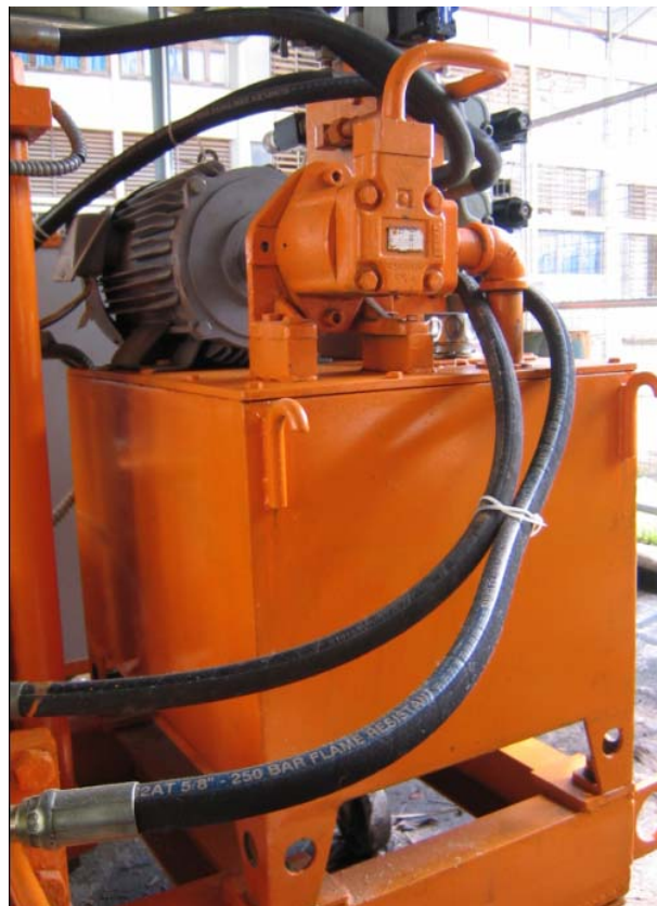
รูปที่ 4.2 ชุดต้นกำลังของระบบไฮดรอลิก
