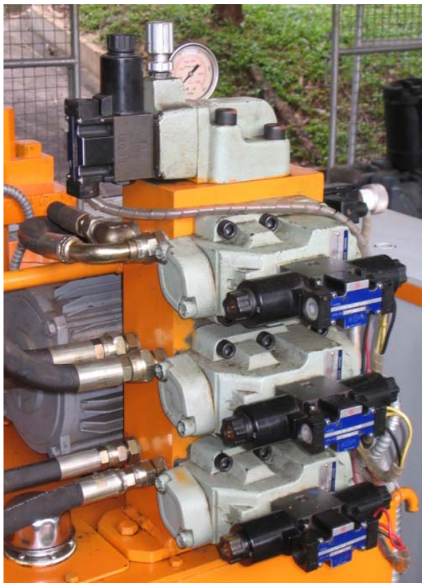
รูปที่ 4.3 เรือนแยกน้ำมัน และโซลินอยด์วาล์ว
