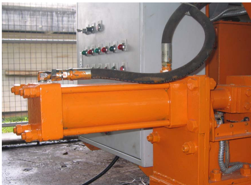
รูปที่ 4.4 ครอบอกไฮดรอลิกครอบอกที่หนึ่ง
