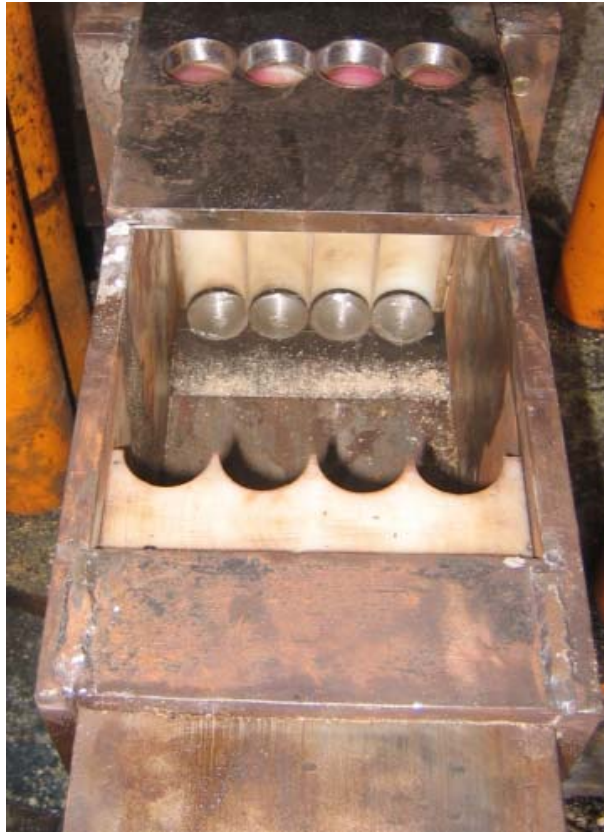
รูปที่ 4.6 รางรับและป้อนฝุ่นไม้ (ไม่ได้แสดงถึงเก็บฝุ่นไม้ซึ่งต่ออยู่ด้านล่าง)
