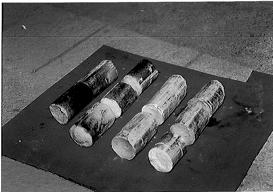
รูป 3.18 แท่งฝุ่นที่อัดได้และมีการให้ความร้อนที่แม่พิมพ์
