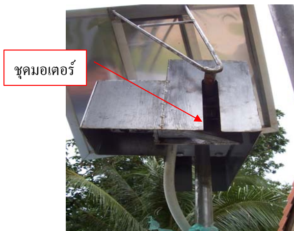
รูปที่ 4.8 ชุดมอเตอร์ของระบบติดตามดวงอาทิตย์
