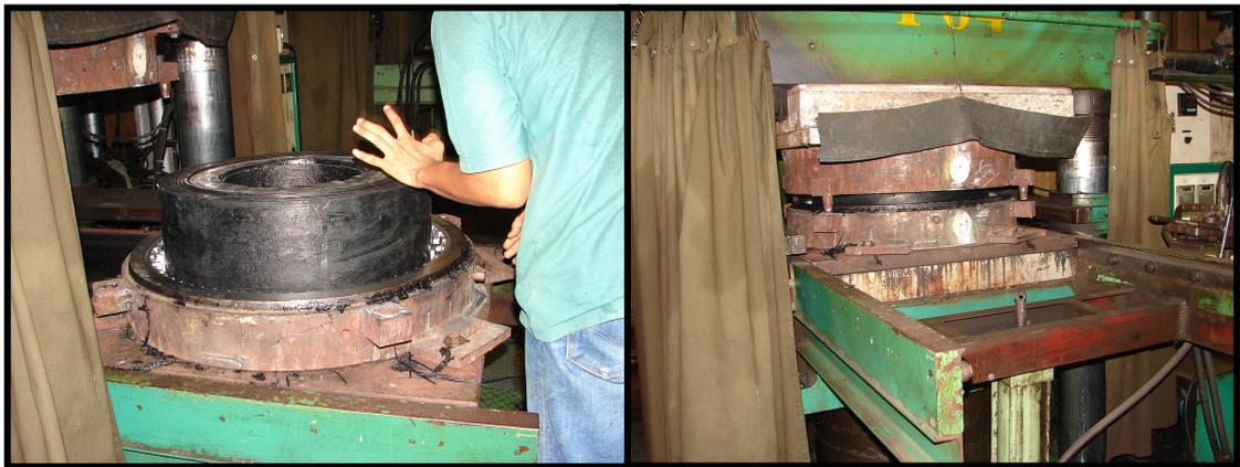
รูปที่ 2.22 นำตัวอย่างมาวางในแม่พิมพ์ตัวล่าง      รูปที่ 2.23 แสดงการประกบกันของแม่พิมพ์ตัวบนและตัวล่าง
