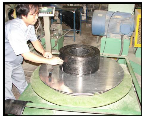
รูปที่ 2.20 นำล้อยางที่ผ่านการม้วนขึ้นรูปมาซึ่งให้ได้น้ำหนักตามที่กำหนด
