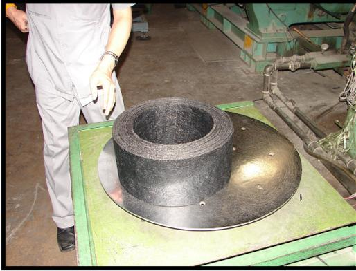
รูปที่ 2.17 นำยางชั้นในที่ผ่านการม้วนขึ้นรูปมาซึ่งให้ได้น้ำหนักตามที่กำหนด
