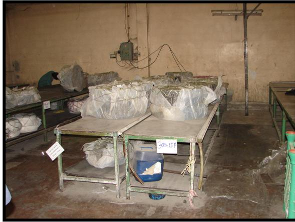
รูปที่ 2.21 แสดงการเก็บตัวอย่างที่ม้วนขึ้นรูปแล้วก่อนนำไปอบ
