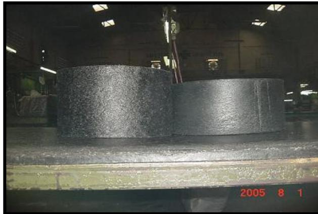
รูปที่ 2.30 แสดงยางชั้นในที่ไม่ได้อัดกับยางชั้นในที่ได้อัด
