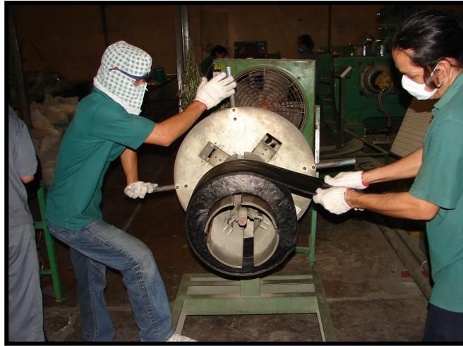
รูปที่ 2.11 แสดงการม้วนขึ้นรูปล้อยางชั้นในด้วยเครื่องม้วนแบบเก่า
