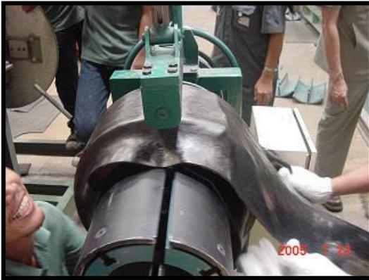
รูปที่ 2.3 การพันยางชั้นในด้วยเครื่องมือหมุนยาง
