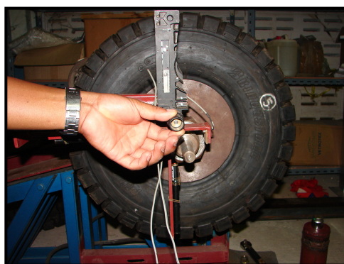
รูปที่ 4.35 แสดงการติดตั้งและปรับระยะการบัง ลำแสง
