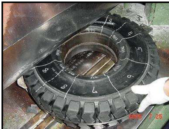
รูปที่ 4.2 การตัดล้อยางออกเป็น 2 ส่วน
