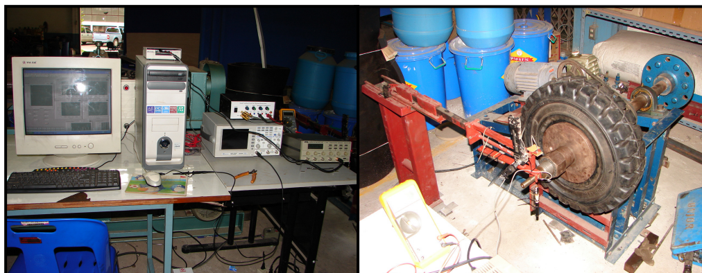
รูปที่ 4.25 ข). เครื่องทดสอบความสมดุลแรงเหวี่ยงรอบแกนหมุนของล้อยางตันที่สร้างเสร็จแล้ว รูปที่ 4.25 เครื่องทดสอบความสมดุลแรงเหวี่ยงรอบแกนหมุนของล้อยางตัน
