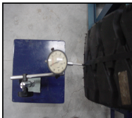
รูปที่ 4.11 การวัดความกลมของล้อยางตันโดยใช้ไดอัลเกจสัมผัสหน้ายางโดยตรง
