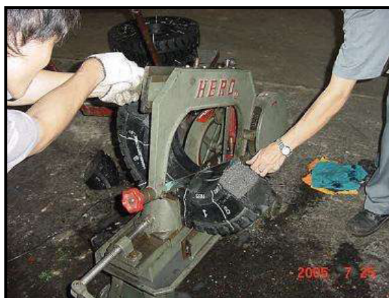
รูปที่ 4.3 ใช้เลื่อยตัดย่อยออกเป็น 10 ส่วน
