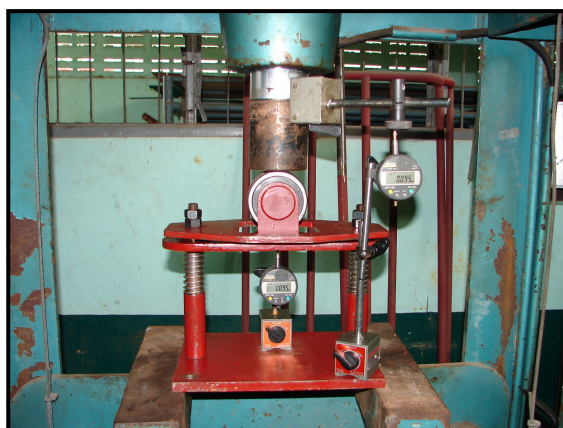
รูปที่ 4.14 การปรับเทียบหาความคลาดเคลื่อนของระยะการเคลื่อนที่ของชุดลูกกลิ้ง
