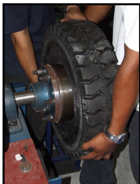
รูปที่ 4.32 แสดงการประกอบล้อยาง รูปที่ 4.33 แสดงการประกอบล้อยางกับกระทะล้อด้านนอก กับกระทะล้อด้านใน
