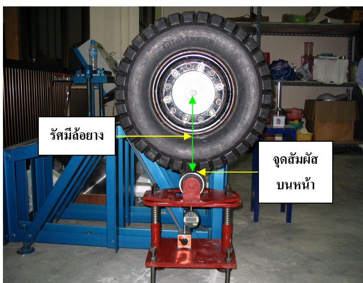
รูปที่ 4.24 แสดงการวัดความกลมของล้อยางต้น
