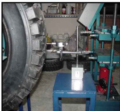
รูปที่ 4.11 การวัดความกลมของล้อยางตันโดยใช้ไดอัลเกจสัมผัสหน้ายางโดยตรง
