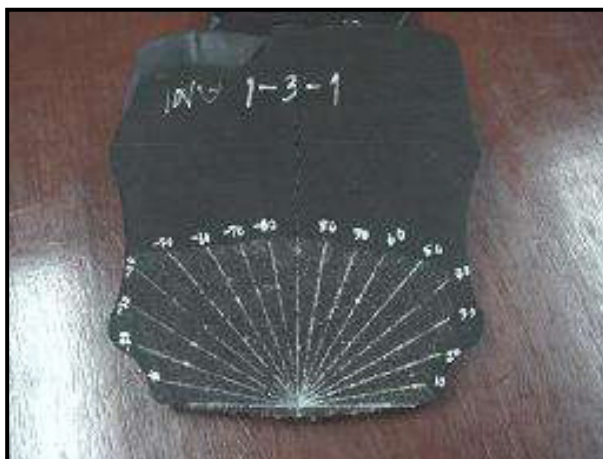
รูปที่ 4.4 หน้าตัดของล้อยางต้นที่ทำการแบ่งส่วน
