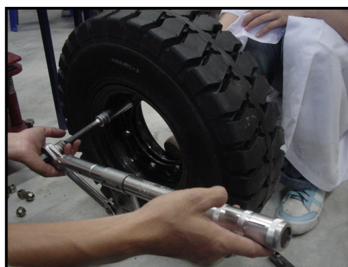
รูปที่ 4.18 ชันแป้นเกลียวบีบกระทะล้อให้ประกบกัน
