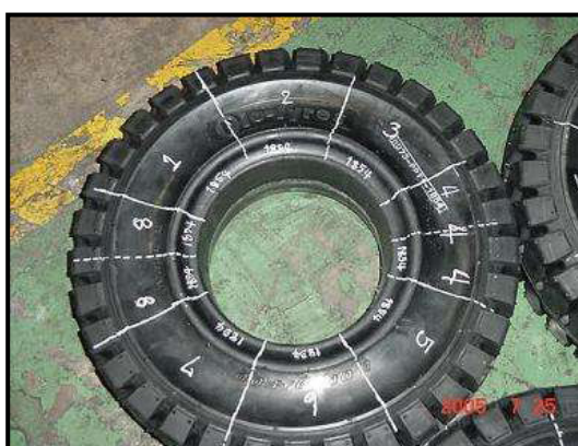
รูปที่ 4.1 ขีดเส้นแบ่งล้อยางออกเป็น 8 ส่วนพร้อมขีดเส้นประ
