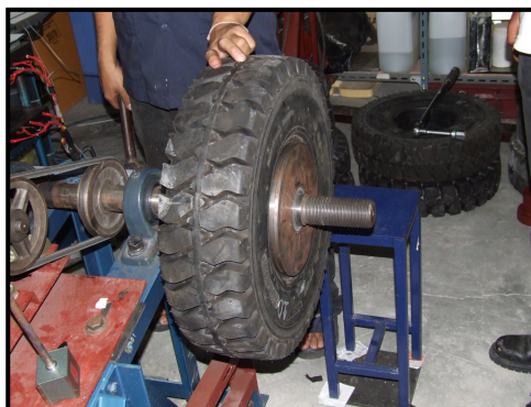
รูปที่ 4.32 แสดงการประกอบล้อยาง รูปที่ 4.33 แสดงการประกอบล้อยางกับกระทะล้อด้านนอก กับกระทะล้อด้านใน
