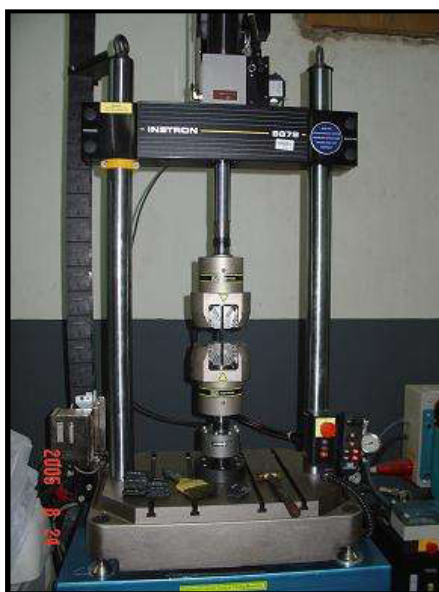
รูปที่ 4.7 เครื่อง Universal Testing Machine สำหรับทดสอบการดึง
