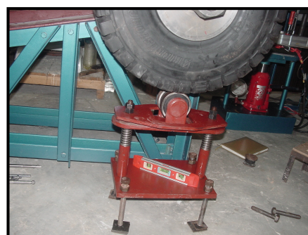
รูปที่ 4.23 นำชุดลูกกลิ้งเข้ามาติดตั้งและตรวจสอบระดับ
