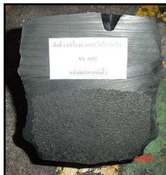
รูปที่ 5.1 แสดงตัวอย่างหน้าตัดของล้อยางตัน
