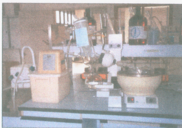
ภาพประกอบภาคผนวก 8 ลดปริมาตรตัวอย่างด้วยเครื่อง Rotary Evaporator
