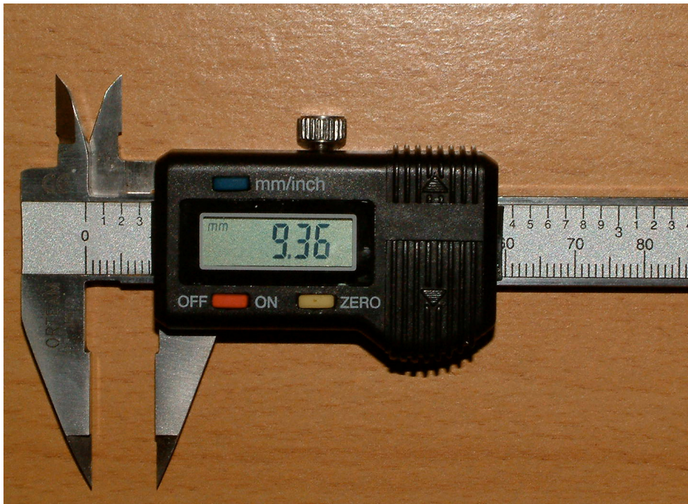
รูปที่ 1 เครื่องมือเวอร์เนียคาลิปเปอร์แบบดิจิทัล (digital vernier caliper)
