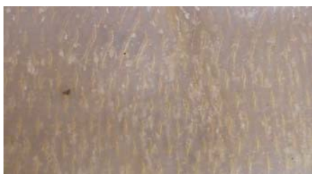
รูปที่ 3 ฟองอากาศที่อยู่ในเนื้อยางแผ่นดิบ
