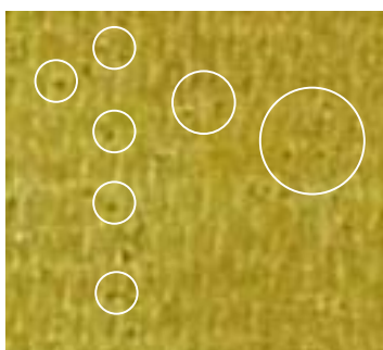
รูปที่ 51 ยางแผ่นที่แสงส่องผ่านปรากฏเห็นฟองอากาศ
