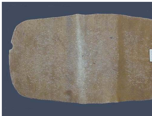
รูปที่ 25 แผ่นยางทดสอบที่มีราขาวปกคลุม
