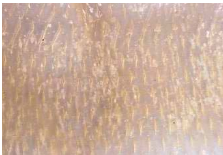
รูปที่ 50 ฟองอากาศของยางแผ่น
