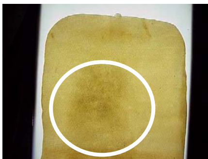
รูปที่ 69 ลายดำเป็นหย่อมๆ ที่ปรากฏหลังจากส่องแสง
