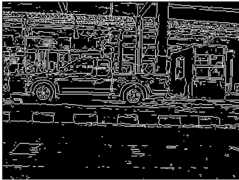
รูปที่ 2.4 ก การหาขอบภาพด้วยวิธี Sobel
