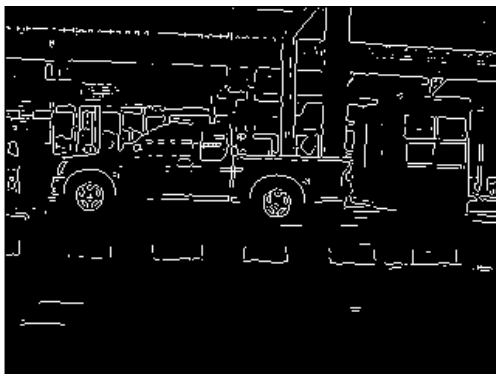
รูปที่ 2.4 ค การหาขอบภาพด้วยวิธี Laplacian
