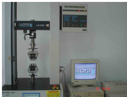
ภาพประกอบที่ 26 แสดงเครื่องทดสอบสมบัติด้านการดึง
