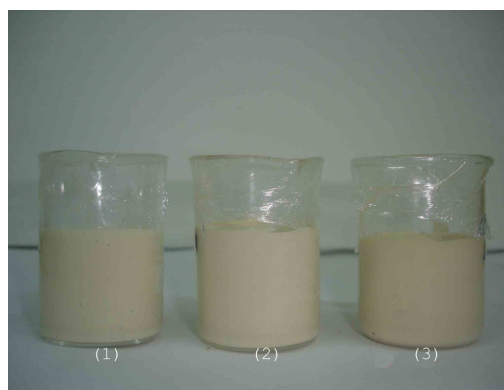
C : กาวยางที่ผสมคิวมาโรนอิมัลชันปริมาณต่างๆ : (1) 6 phr (2) 7 phr (3) 8 phr
