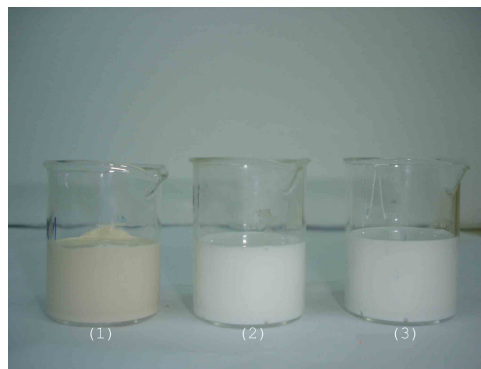
A : (1) กาวยางที่ไม่ได้ใส่สารเพิ่มการยึดติด (2) กาว TOA (3) กาว UF
