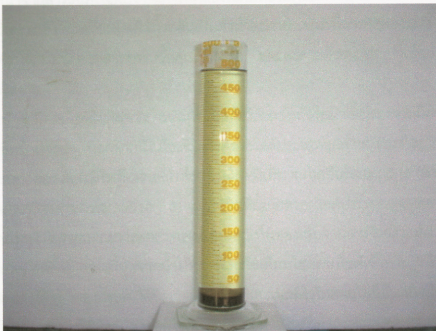
ภาพประกอบ 14 ส่วนใสที่มีสีเขียวแกมเหลืองเนื่องจากการละลายของตะกอนโลหะหนัก
