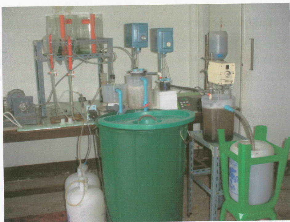
ภาพประกอบ 13 ชุดอุปกรณ์บำบัดของเสียจากการวิเคราะห์ค่าซีโอดีแบบต่อเนื่อง
