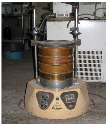
ภาพประกอบที่ 5 ชุดตะแกรงร่อนตามมาตรฐานไทเลอร์
