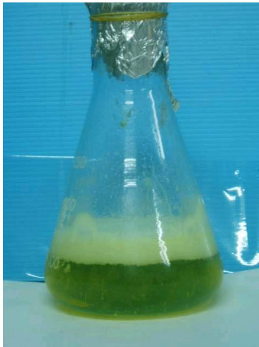
ภาพที่ 26 สารที่ควบแน่นออกมาเมื่อใช้สัดส่วนโมลกลีเซอรอลต่อไฮปาล์มสเตียริน 2.5 ต่อ 1 ที่อุณหภูมิการทำปฏิกิริยา 250 องศาเซลเซียส
