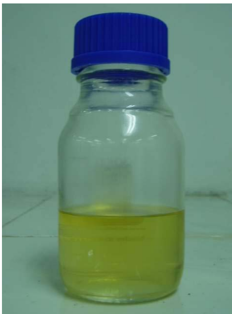
ภาพที่ 38 หลังจากผสมตัวทำละลายกับตัวอย่างสารเมื่ออุ่นให้ความร้อนที่ 70 องศาเซลเซียส
