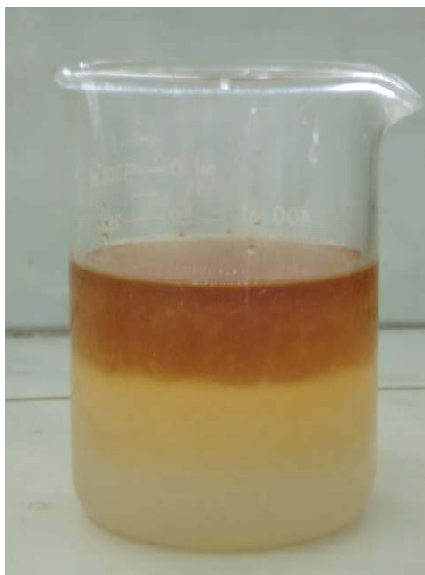
ภาพที่ 34 การล้างกลีเซอรอลหลังทำปฏิกิริยาด้วยการหยดน้ำร้อนลง
