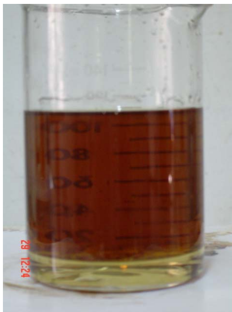
ภาพที่ 35 การแยกชั้นของกลีเซอรอลเมื่อเติมกรดไฮโดรคลอริกลงไป
