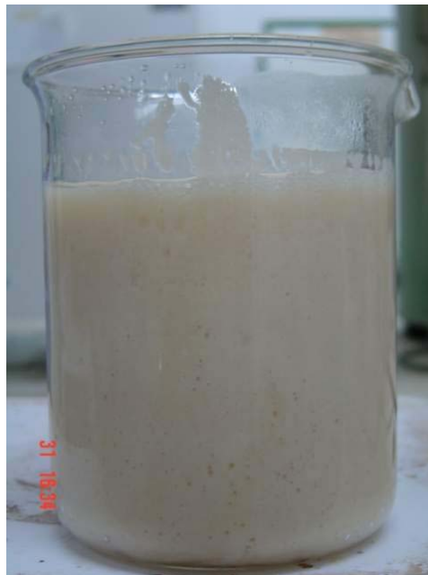
ภาพที่ 33 สารหลังทำปฏิกิริยาล้างแบบกวนผสมกับน้ำ
