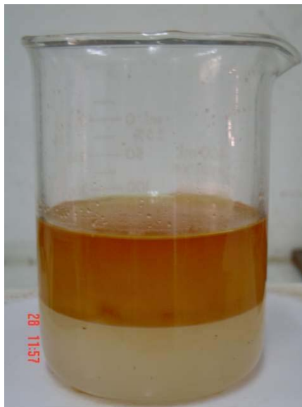
ภาพที่ 36 การแยกชั้นของน้ำหลังเติมลงไปในสารที่ผ่านการปรับสภาพให้เป็นกลางแล้ว
