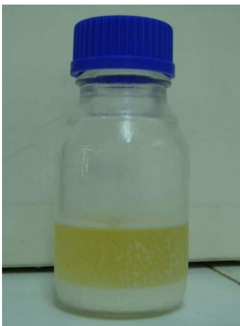
ภาพที่ 39 การแยกชั้นของผลึกหลังตั้งให้เกิดการตกผลึก
