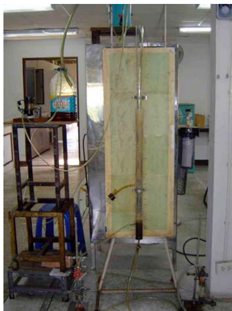
ภาพประกอบ 2.5 แสดง Catalytic Ozonation Unit (Continuous System), ใช้ในการทดลองจริง
