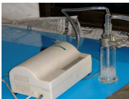
ภาพประกอบที่ 7 แสดงชุดอุปกรณ์การทดลองปฏิกิริยาไอโซเนชัน
