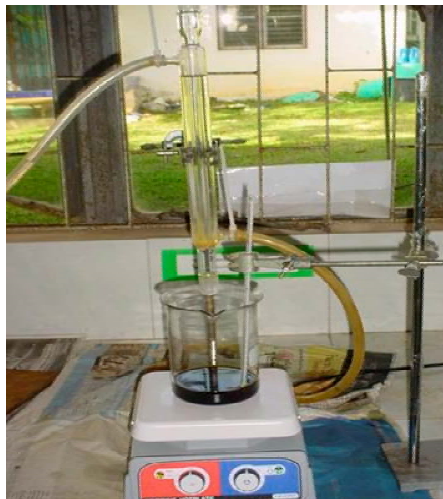
ภาพประกอบที่ 6 แสดงชุดการทดลองแบบรีฟลักซ์ในการผลิตเมทิลเอสเทอร์
