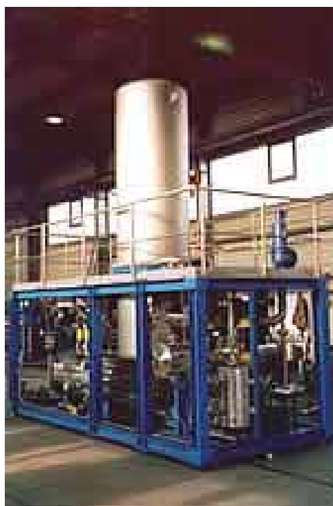
ภาพประกอบ 1.17 โรงงานต้นแบบ (pilot plant) ที่มีกำลังการผลิตเอทานอล 1,000 ตัน/ปี ของบริษัท Sulzer Chemtech ที่มา: Sulzer Chemtech, 2006
