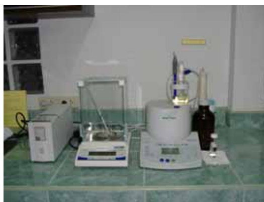
ภาพประกอบ ก.2 เครื่อง Karl Fisher Coulometer ของบริษัท Mettler รุ่น DL39
