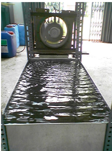
ภาพประกอบ 1 ถังระเหยที่สามารถปรับระดับความลึกของแหล่งน้ำได้
