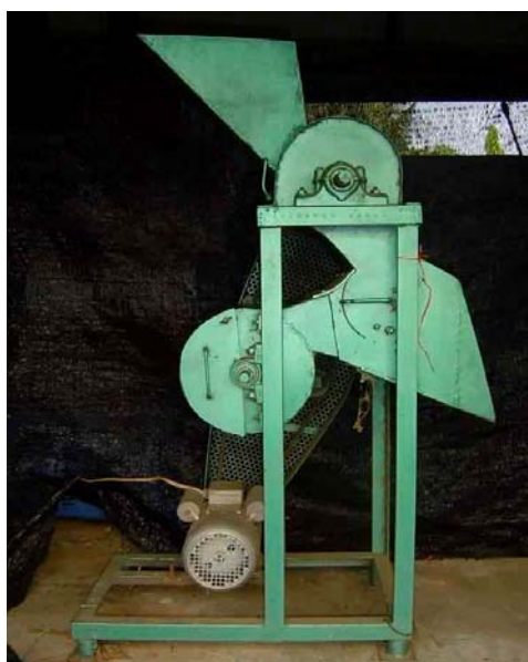
รูปที่ 14 เครื่องกระเทาะเปลือกเมล็ดขางพารา
