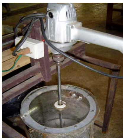
รูปที่ 15 เครื่องสกัดน้ำมันด้วยตัวทำละลายแบบถึงกวน
