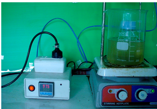
ภาพประกอบที่ 14 แสดงชุดทำการทดลองปฏิกิริยาเอสเตอริฟิเคชัน
