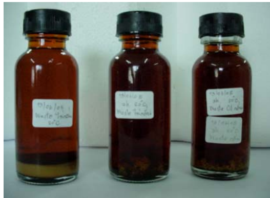
ภาพประกอบที่ 51 ลักษณะทางกายภาพของเมทิลเอสเทอร์ที่ผลิตได้จากกระบวนการแบบเบทซ์
