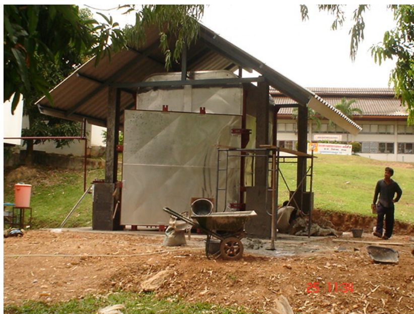
ภาพประกอบที่ 2-6 ห้องอบแห้งไม้ยางด้วยไอน้ำยิ่งยวดและลมร้อนที่ใช้สำหรับการศึกษาวิจัย
