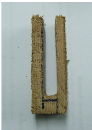
ภาพประกอบที่ ข-18 ไม้ยางหลังอบแห้งที่ไม่ผ่านการทดสอบแบบซีลล้อม
