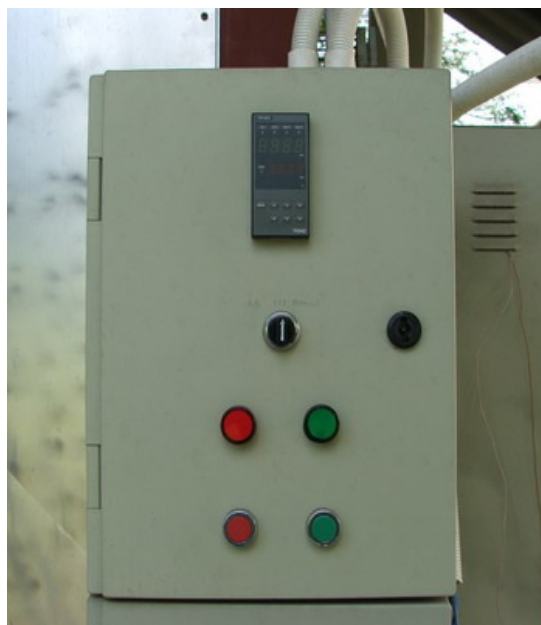
ภาพประกอบที่ ง-8 กล่องควบคุมการเปิดปิดวาล์วเพื่อควบคุมความชื้น
