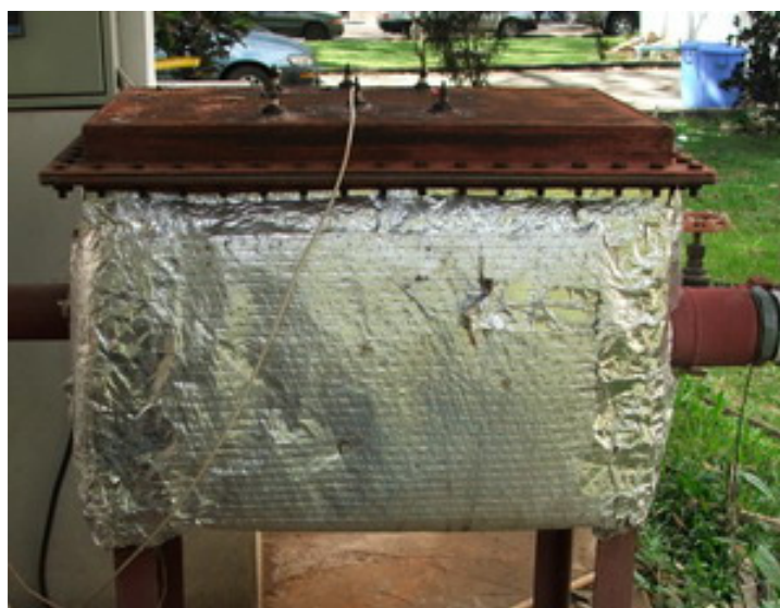
ภาพประกอบที่ ง-2 เครื่องทำความร้อนภายนอกห้องอบไม้ยาง
