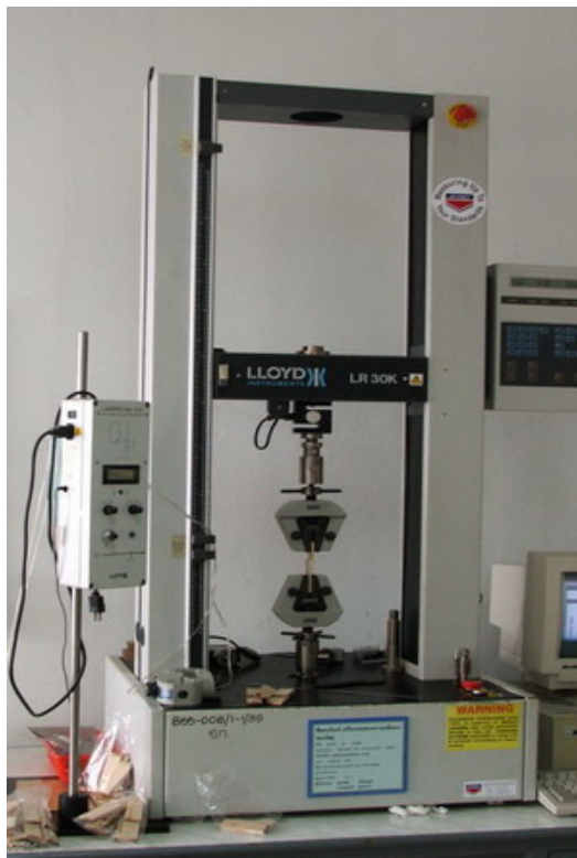
ภาพประกอบที่ ง-13 เครื่องทดสอบคุณสมบัติเชิงกลของไม้ยาง (Lloyd Universal Testing Machine)
