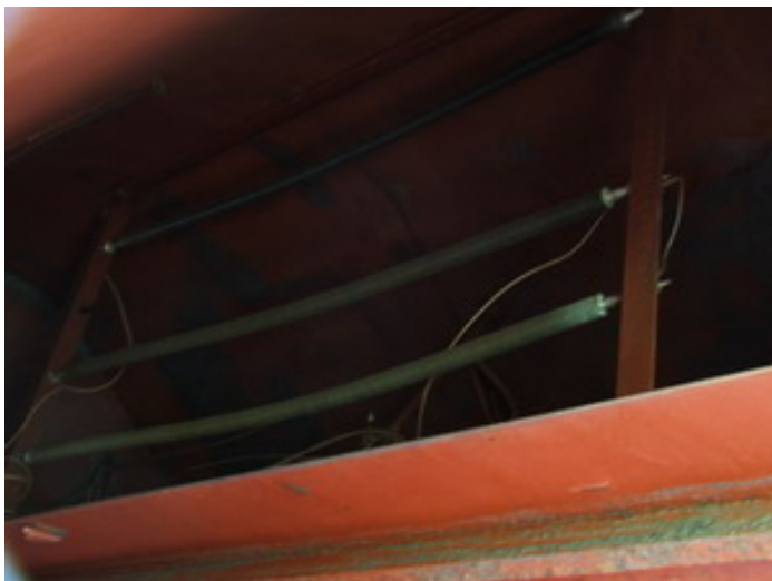
ภาพประกอบที่ ง-5 เครื่องทำความร้อนภายในห้องอบไม้ยาง
