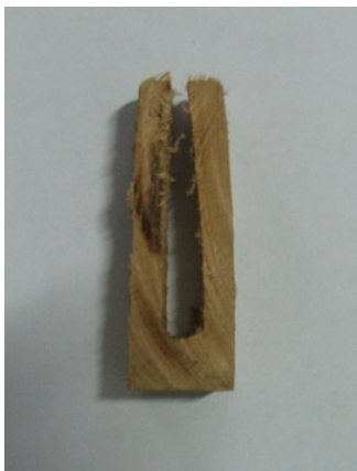
ภาพประกอบที่ ข-15 ไม้ยางหลังอบแห้งที่ไม่ผ่านการทดสอบแบบชีส์้อม
