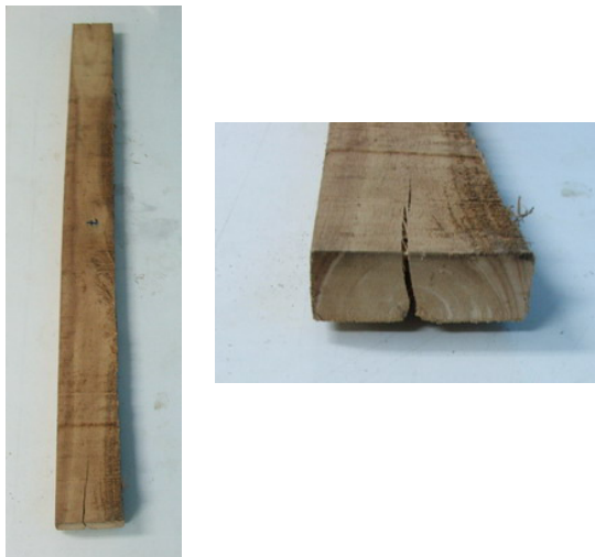
ภาพประกอบที่ ข-11 ลักษณะของไม้ยางหลังอบแห้งของการทดลองที่ 9 มีลักษณะที่ไม่ดี ไม่มีการแตกบริเวณปลายมาก
