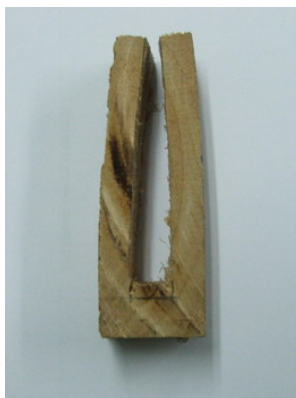
ภาพประกอบที่ ข-13 ไม้ยางหลังอบแห้งที่ไม่ผ่านการทดสอบแบบชีส์้อม
