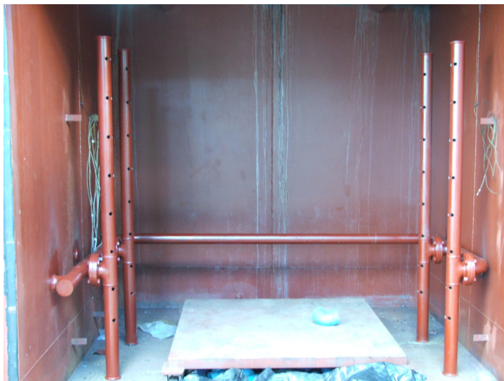
ภาพประกอบที่ ง-11 ลักษณะการวางตัวของท่อลำเลียงไอน้ำและลมร้อนที่ใช้งานจริง
