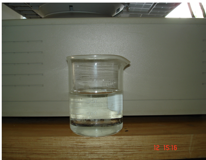
ภาพประกอบ 42 แสดงภาพน้ำเสียตัวอย่างหลังจากกรองด้วยไมโครฟิลเตรชันแบบไหลขวางผ่านเซลลูโลสไนเตรทเมมเบรนขนาด 5 micron สำหรับการกรองน้ำเสียที่ความเข้มข้น 1500 mg/l ความดัน 5 psi และอัตราการไหล 1.75 Lpm
