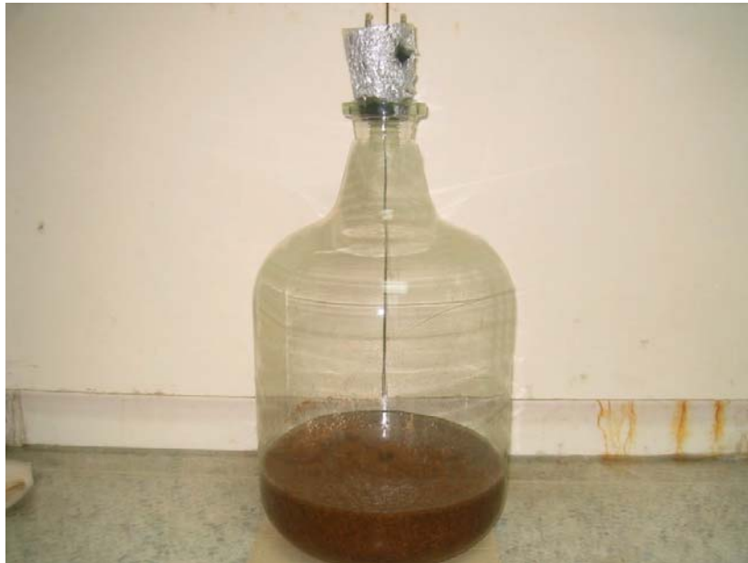
ภาพที่ 5 การแช่ขุ่ยสกัดสารออกฤทธิ์จากเมล็ดสะเดาช้าง ด้วยนอร์มอลเฮกเซน (n-hexane) หรือเมทานอล (methanol)
