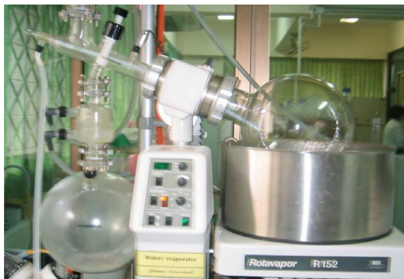
ภาพที่ 6 การระเหยสารสกัดด้วยเครื่อง rotary evaporator
