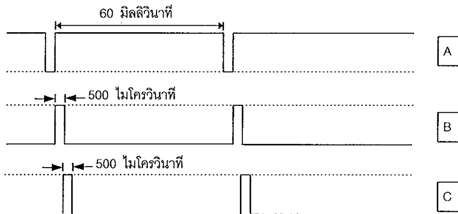
ภาพประกอบ 3.14 แสดงรูปร่างของสัญญาณไฟฟ้าที่ผ่านออกมาจาก วงจรอินทิเกรเตอร์
