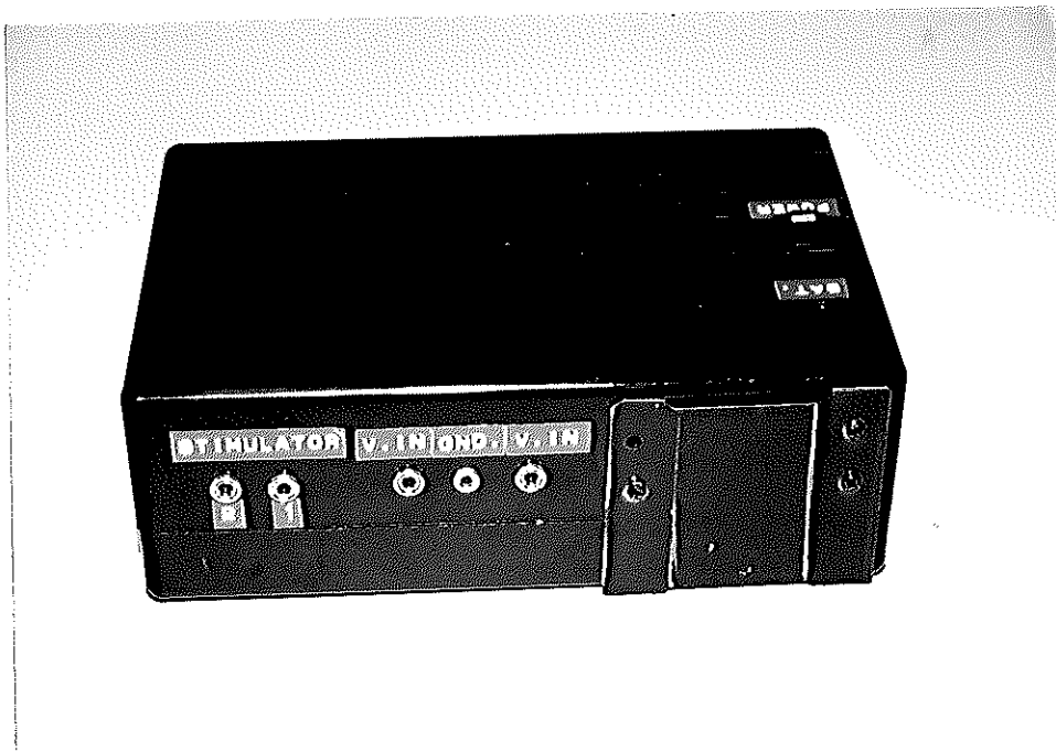
ภาพประกอบ 4.1 เครื่องกระตุ้นไฟฟ้าเชิงลำดับแสดงให้เห็นถึงช่องเสียบอิเล็กโทรด สวิตช์และแอลซีดีแสดงพลังงานของแบตเตอรี่
