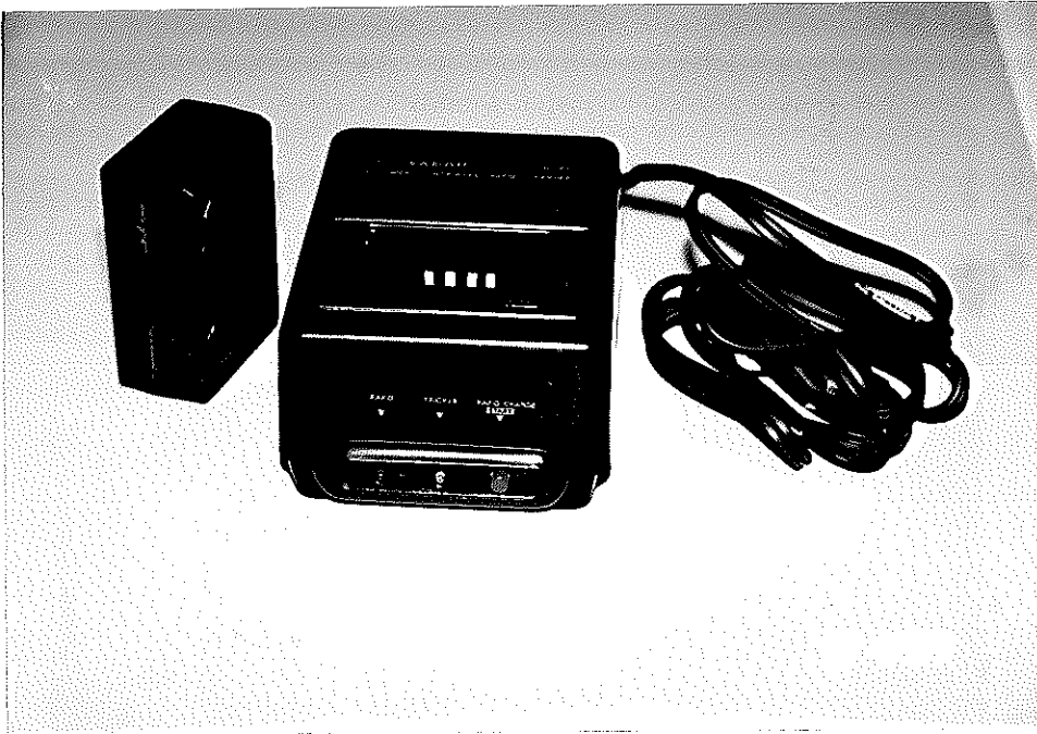
ภาพประกอบ 4.6 แสดงเครื่องชาร์จแบตเตอรี่ยี่ห้อ NAC รุ่น NC-42 และแบตเตอรี่ที่ใช้กับเครื่องกระตุ้นไฟฟ้าเชิงลำดับ
