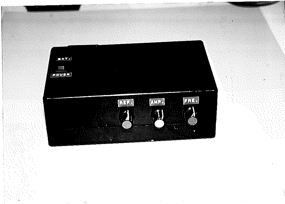
ภาพประกอบ 4.2 เครื่องกระตุ้นไฟฟ้าเชิงลำดับแสดงให้เห็นถึงปุ่มปรับระดับแรงดันของสัญญาณอ้างอิง, ปุ่มปรับระดับแรงดันของสัญญาณกระตุ้นกล้ามเนื้อ และ ปุ่มปรับความถี่ของสัญญาณกระตุ้นกล้ามเนื้อ
