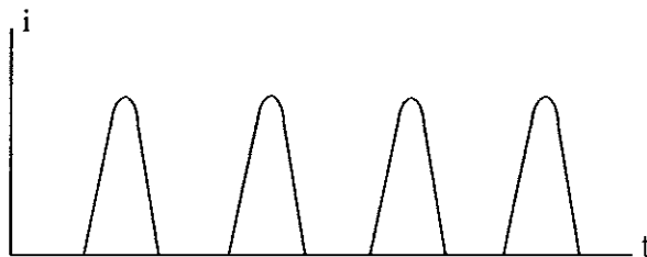
ภาพประกอบ 2.4 แสดงกระแสฟาราดีคที่เป็นกระแสตรง
