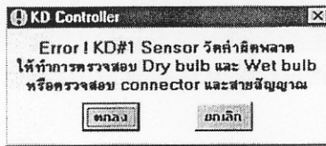
ภาพประกอบ ก-22 Dry & Wet bulb error
