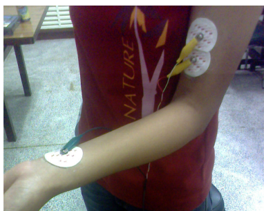
ภาพประกอบ 5-2 ลักษณะของการติดอิเล็กโทรดที่ตำแหน่งไบเซ็ป
