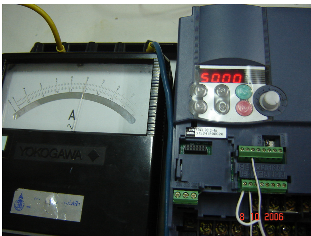
ภาพประกอบ 4-7 ผลการทำงานของอินเวอร์เตอร์เมื่อปริมาณโหลดค่ามาก
