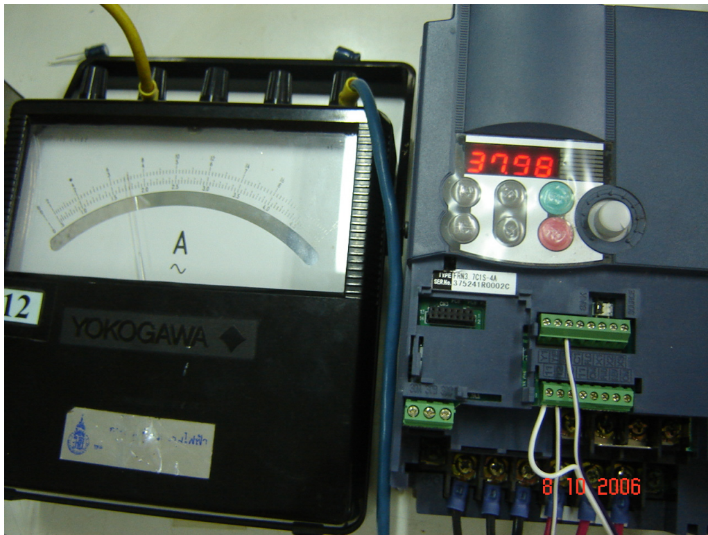
ภาพประกอบ 4-5 ผลการทำงานของอินเวอร์เตอร์เมื่อปริมาณโหลดค่าน้อย
