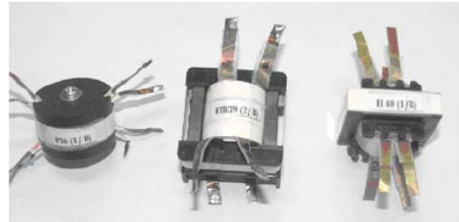
รูปที่ 5 หม้อแปลงความถี่สูงที่ใช้ในการทดสอบ
