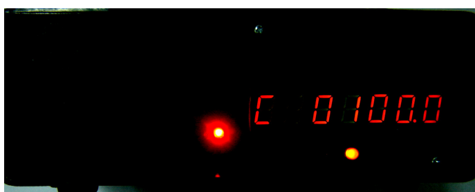
ภาพประกอบ 4-17 ยอดเงินในเครื่องวัดพลังงานไฟฟ้า
