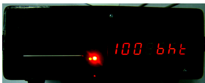
ภาพประกอบ 4-19 เครื่องวัดพลังงานไฟฟ้าจะแสดงยอดเงินที่มีอยู่ภายในบัตรให้ผู้ใช้ไฟทราบ
