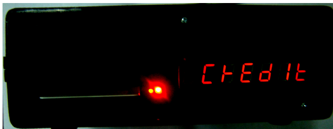
ภาพประกอบ 4-18 เมื่อเสียบชิปการ์ดเครื่องวัดพลังงานไฟฟ้าจะตรวจสอบข้อมูลภายในบัตร
