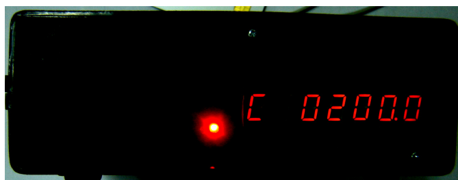
ภาพประกอบ 4-20 เครื่องวัดพลังงานไฟฟ้าถ่ายโอนมูลค่าเงินแล้วทำการบวกเพิ่มมูลค่าเงินจากที่มีอยู่เดิม
