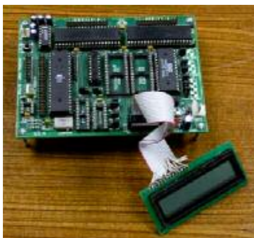
ภาพประกอบ 2-6 การเชื่อมต่อ LCD เข้ากับบอร์ด ANT-32
