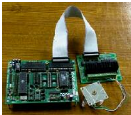
ภาพประกอบ 2-5 การเชื่อมต่อ Stepping Motor และบอร์ดขับเคลื่อนเข้ากับบอร์ด ANT-32
