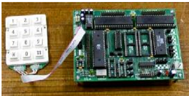
ภาพประกอบ 2-7 การเชื่อมต่อ Keypad เข้ากับบอร์ด ANT-32
