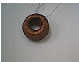
รูปที่ 3.4 แกนเฟอร์ไรท์
